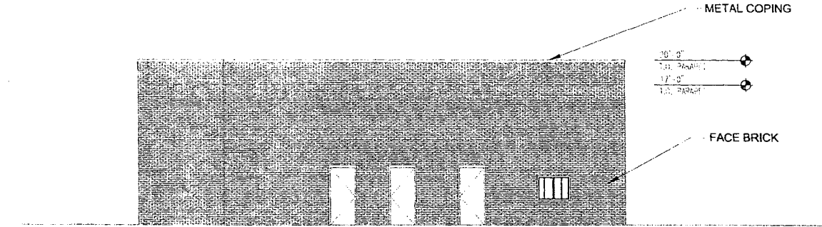
RETAIL A7 - EAST ELEVATION SCALE: 1/8" = 1'-0"
